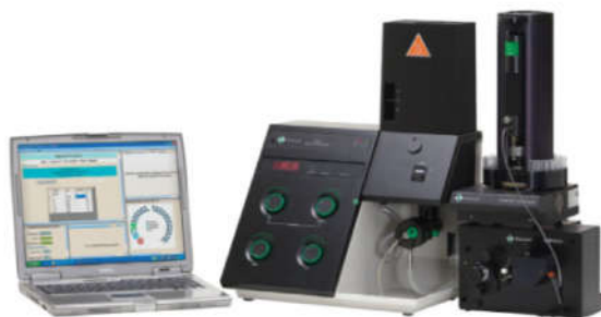
Figur 16.5. Flammefotometer, autosampler, fortynder og pc. (Foto: Sherwood-scientific)
